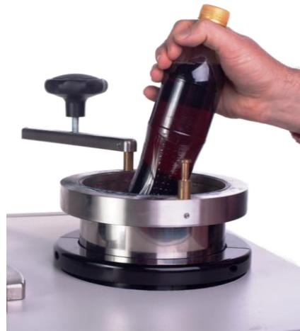
La CO<sub>2</sub> è rivelata misurando lo spettro di assorbimento alla lunghezza d'onda di 4.3 µm così come previsto dalla norma ASTM F2476-05.
