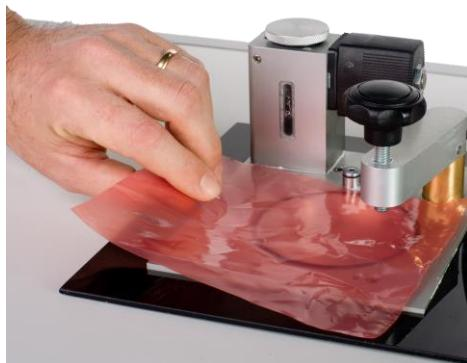
MultiPerm è conforme alle norme DIN 53380-3, ASTM D3985, F2622, F1927, F1307, JIS K-7126, ISO 15105-2 per la misura di O<sub>2</sub>TR, alla norma ASTM F2476 per le misure di CO<sub>2</sub>TR ed alle norme ASTM F1249, TAPPI T557, JIS K-1729, ISO 15106-2 per le misure di WVTR.
